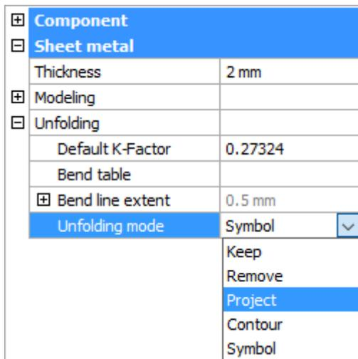
**Abbildung 147:** Unfolding mode
