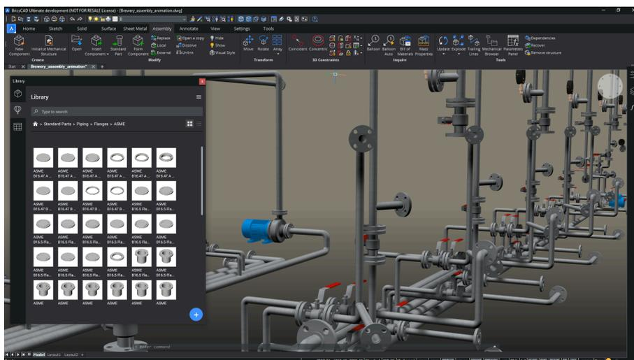
Abbildung 28: Rohrleitungen in der Baugruppenkonstruktion
